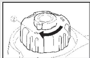
**5** 使用發電機時請選擇地面平整與通風良好的地點。將燃油閥切到ON的位置。
