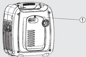
**2** 轉開機油蓋並使用漏斗將機油加滿至刻度中間。加滿約需0.3公升機油，完成後將機油蓋鎖回。換機油時，傾斜機身倒出舊的機油，並從原處添加新的機油。
