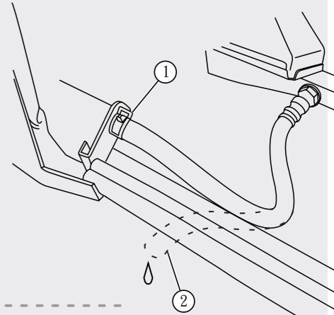
更換機油時，先將卸油管扣環①對壓後往下移動，之後將卸油管②放置於油盤內，等待機油完全漏完後，再將洩油管裝回。
